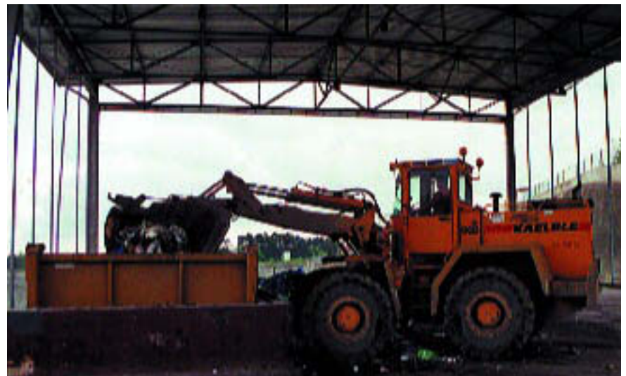
Befüllung des Kippers mit dem Radlader in der Umladestation
